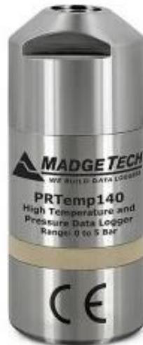
Este datalogger es capaz de medir y registrar temperaturas de  $-20^{\circ}\text{C}$  a  $140^{\circ}\text{C}$  ( $-4^{\circ}\text{F}$  a  $+284^{\circ}\text{F}$ ), y presión absoluta de 0 bar a 5 bar, para una amplia gama de aplicaciones incluso en el condiciones más duras. La capacidad de memoria en el PRTemp140 almacena hasta 32,700 lecturas impresas de fecha y hora y retendrá datos incluso si la batería se descarga.
