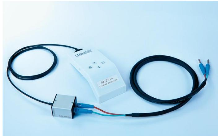
Esta diseñado para medir rápidamente la corriente y el tiempo – Corriente del equipo de X Ray
