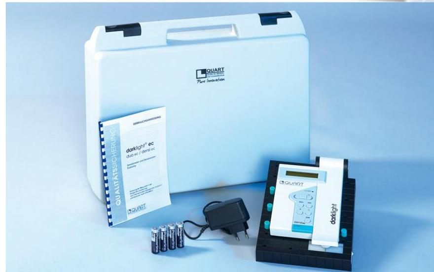
El darkscan duo ref es una combinación de alta precisión de sensitómetro de referencia y densitómetro de escaneo en una sola unidad. Está diseñado para pruebas de aceptación, así como pruebas de rutina diarias de equipos de pantalla de película de rayos X según las normas IEC 61223-2-1, DIN V 6868-55 y DIN 6868-2.
